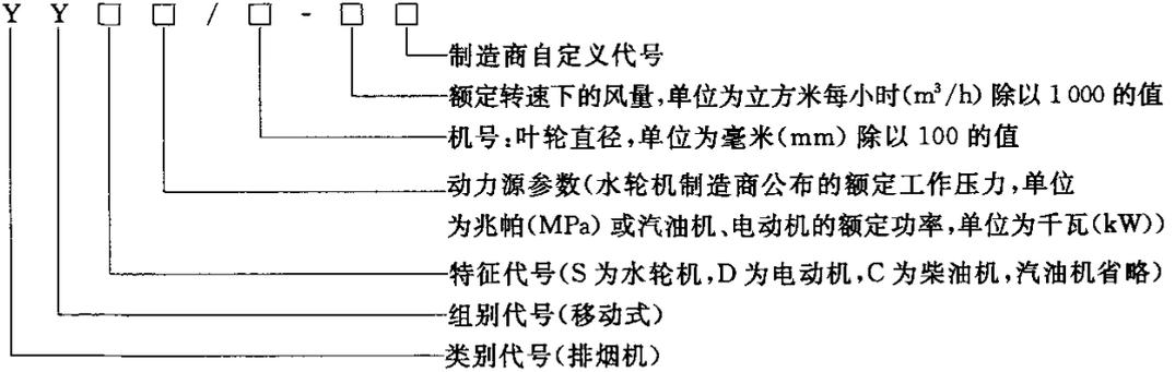
示例 1:内燃机式消防排烟机(汽油机驱动方式),额定功率为 3.5 kW,叶轮直径为 560 mm,额定转速下的最大风量为 12 000 m<sup>3</sup>/h 的排烟机,其型号为 YY3.5/5.6-12。
