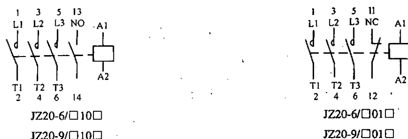
图2 作接触器用时的触头组合接线端标志
